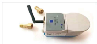
1、检查水表配件、安装天线
