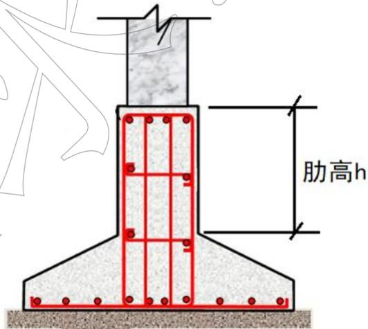
有肋式条形（带形）基础肋高简图
